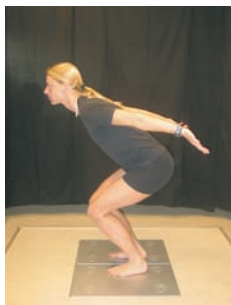
Abb. 13. Dynamometrische Messplattform mit Versuchsperson (Olivier & Rockmann, 2003, S. 38)
